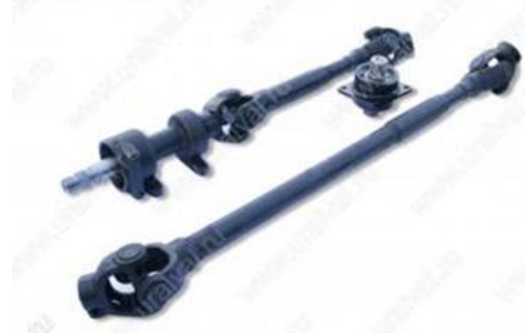
4320Ф-3402073-10 Комплект карданов рулевого управления на а\м с двигателем ЯМЗ-236НЕ2 (под «Борисовский» рулевой механизм). Цена – 11000 руб.
